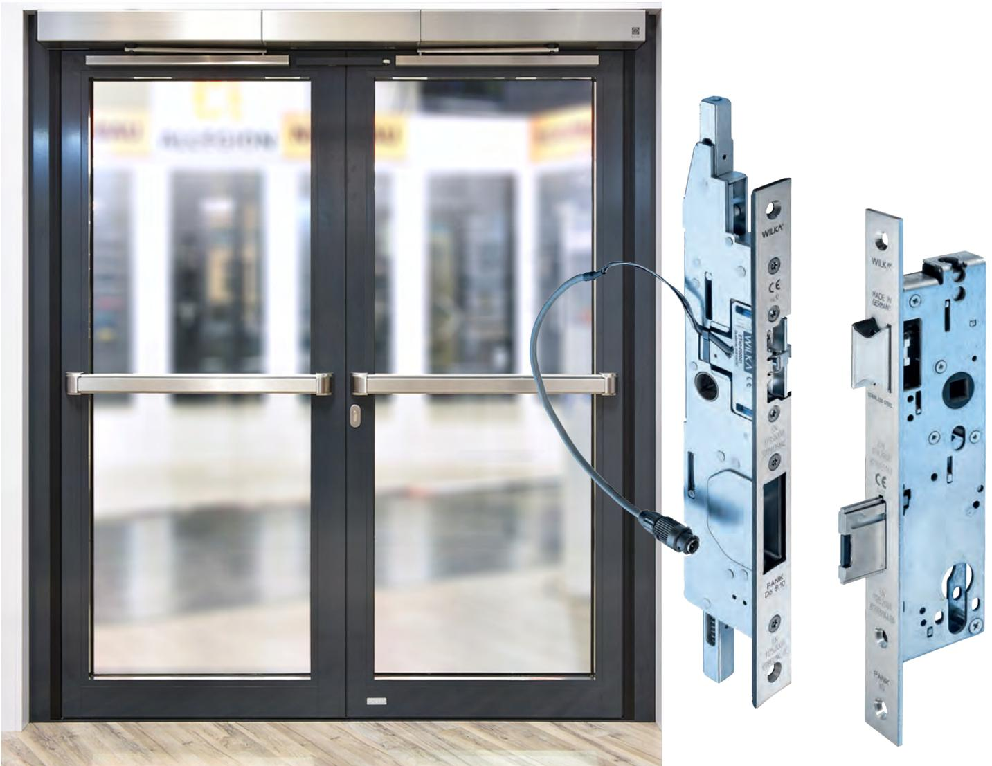
Die Fluchttürserie 6000 mit E-Öffner Gegenkasten ist für den Einsatz in einbruchhemmenden Türen nach EN1627-1630 RC2 geeignet. Gleichzeitig werden mit dieser Serie die Anforderungen der VOB Teil C, DIN 18357 erfüllt.
