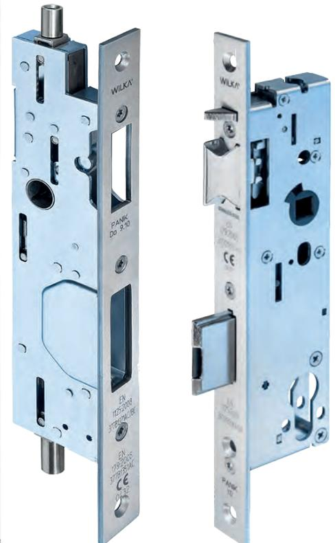
Selbstverriegelnde Fluchttürserie 7000 mit intelligenter Schließfolgeregelung. Ein besonderes Merkmal der Serie 7000 ist die Funktion mit Falle und Riegel. Auf einen Fallen-Riegel wurde bewusst verzichtet, um die Funktion der separaten Sperrelemente zu erhalten.
