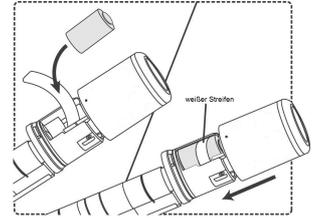
2. Den mechanischen Innenknopf mit dem L-Schlüssel durch Herausdrehen der Madenschraube lösen. Den Zylinder von der Außenseite in das Türblatt einstecken (Zylinder muss leicht einzuschieben sein). Die M5-Stulpschraube ist sorgfältig **von Hand** mit einem handelsüblichen Schraubendreher (kein Akkuschauber) einzuschrauben. Anschließend ist die Freigängigkeit der Schließnase zu prüfen u. ggf. sicherzustellen !!
