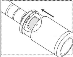
4. Mit dem Montagewerkzeug die Mutter festhalten und die Knopfkappe im Uhrzeigersinn festdrehen.
